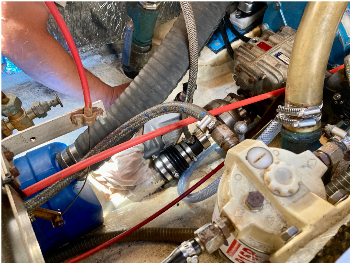
Einbau der neuen PSS-Wellendichtung.
