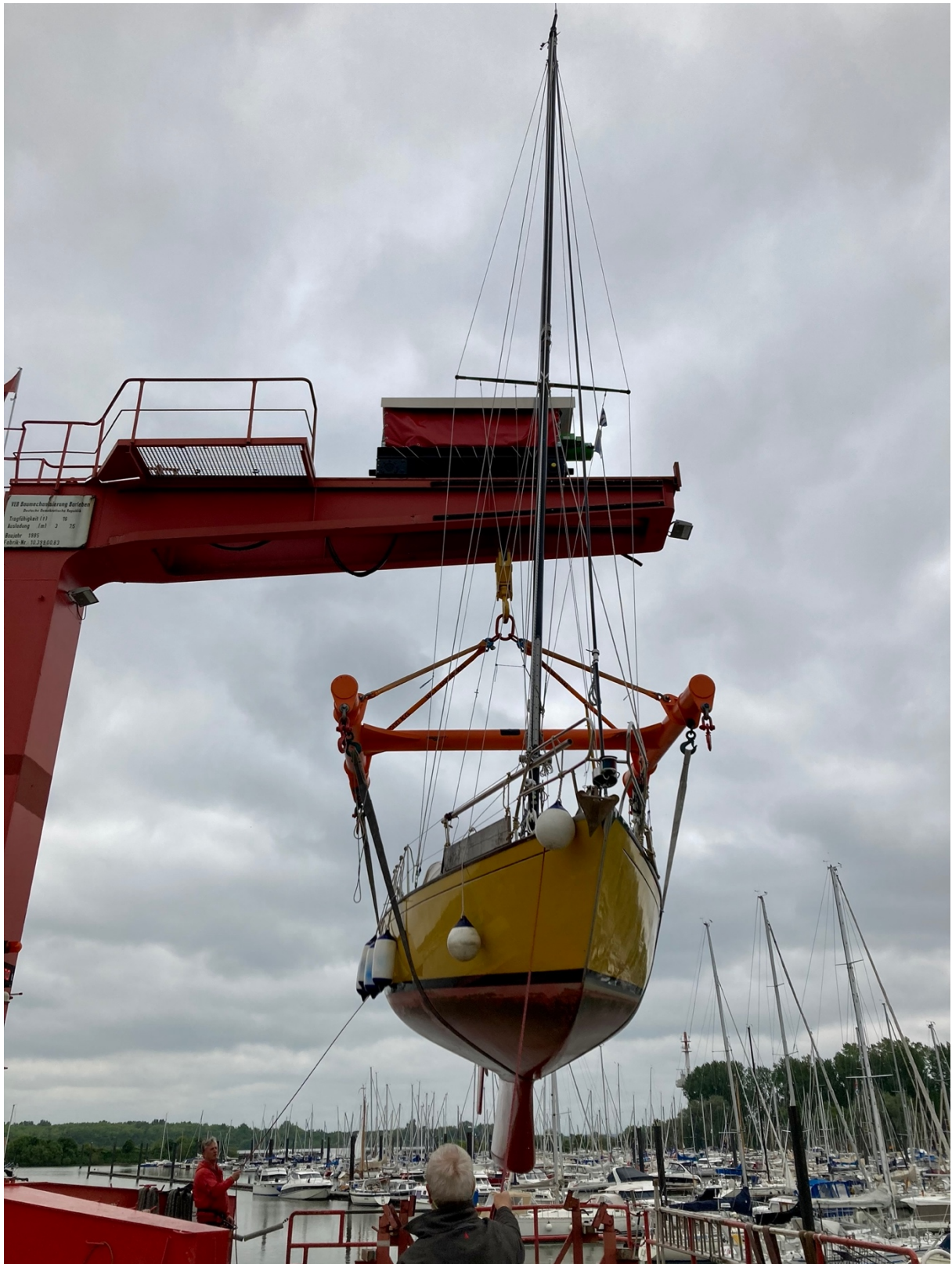
Auskranken mit stehendem Mast
